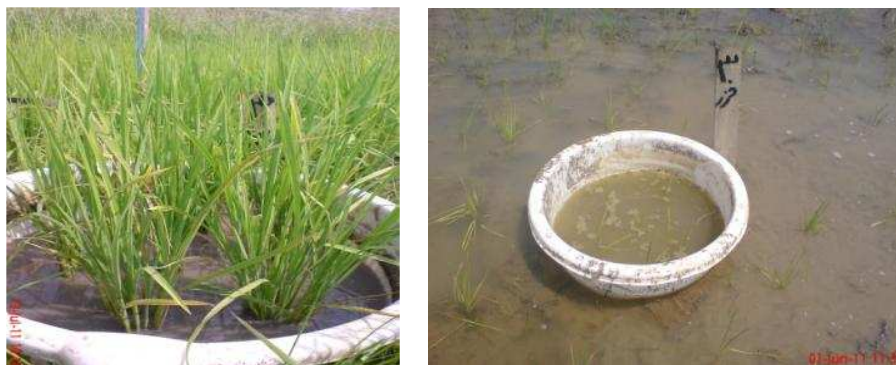
شکل ۱- مینی لایسی متر استوانه‌ای جهت اندازه‌گیری تبخیر-تعرق برنج.
